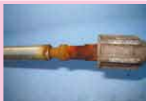
塩害で腐食固着したワイヤーケーブル式のロッド
